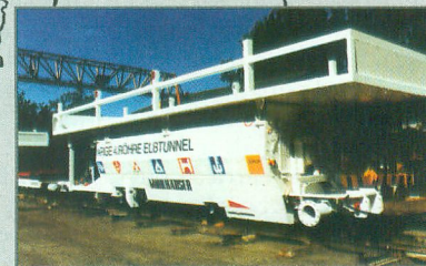
mortarcar for 4. RÖHRE ELBTUNNEL Hamburg
