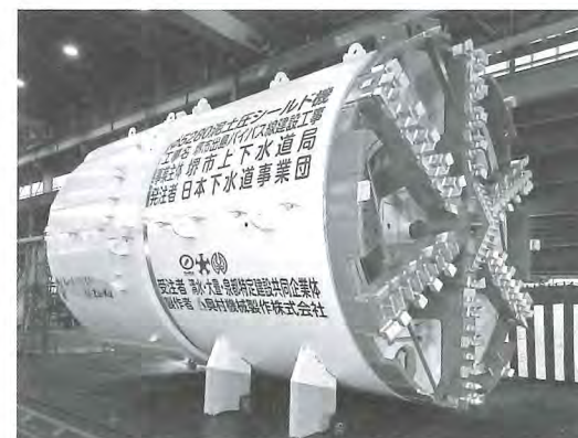
写真-1 シールド全景
