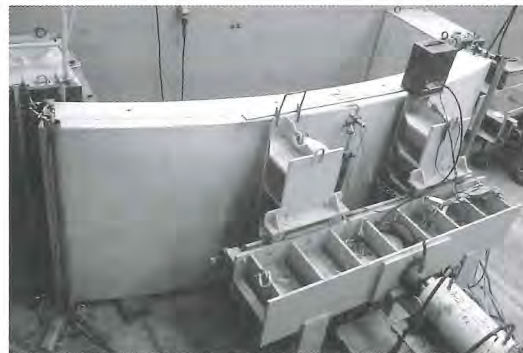
写真-13 切削セグメントの単体曲げ試験の状況
