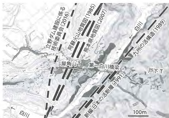
図-3 犀角山トンネルおよび戸下トンネル周辺の地形と断層 6)
