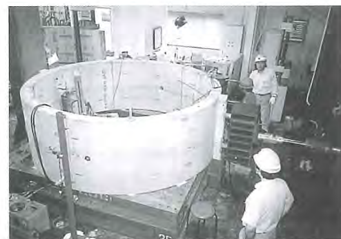
写真-4 リング試験の状況
