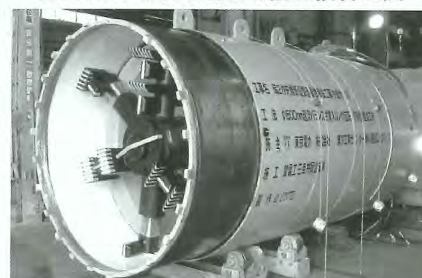
φ1500mm 貫入リング回転切削型掘進機(接合切削時)
