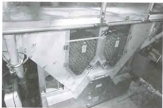
写真-2 爆薬(増ダイ)供給装置
