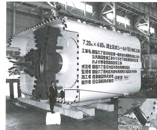
写真-1 泥土圧式シールド(EX-MAC工法)
