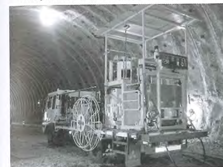
写真は爆薬の遠隔装填装置
