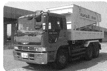
4.5 m³ ベッセル搭載ダンプ
