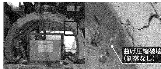
ケース2(樹脂被覆) delta=70mm 写真-5 試験体の破壊状況
