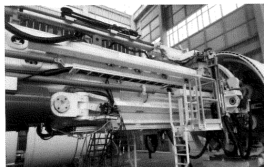
TBM 搭載型先進ボーリングマシン Probe Drilling System
