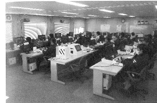
写真-9 無人掘削(ショベルの遠隔操作)状況
