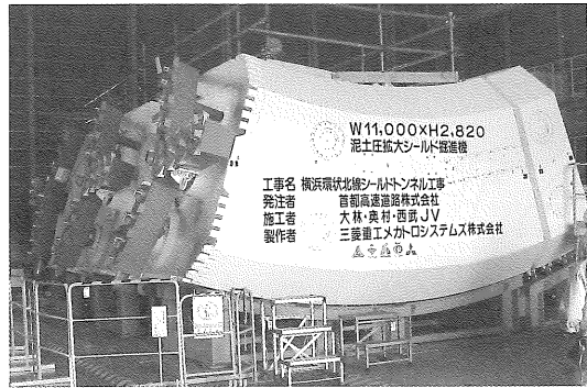
写真-2 拡大シールド全景
