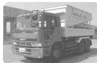
4.5m 3 ベッセル搭載ダンプ
