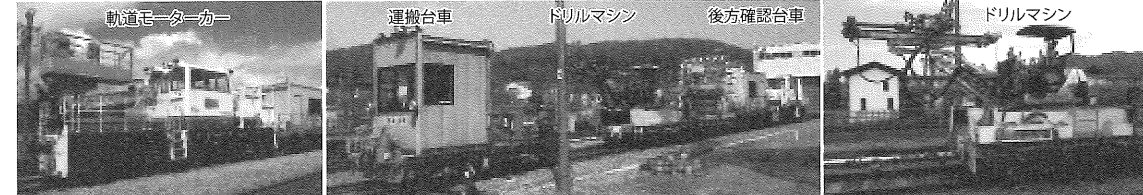
図-5 施工機械編成概要図
