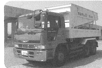
4.5m 3 ベッセル搭載ダンプ
