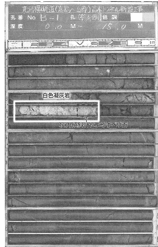
写真-5 白色凝灰岩(B-1 ボーリング)
