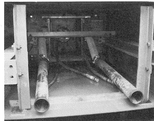
写真-2 まがる一ふ工法の掘削装置(刃口方式(上:前面, 下:背面))
