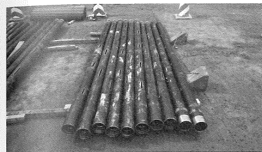
写真-1 中尺ボーリング用鋼管(スリット加工)
