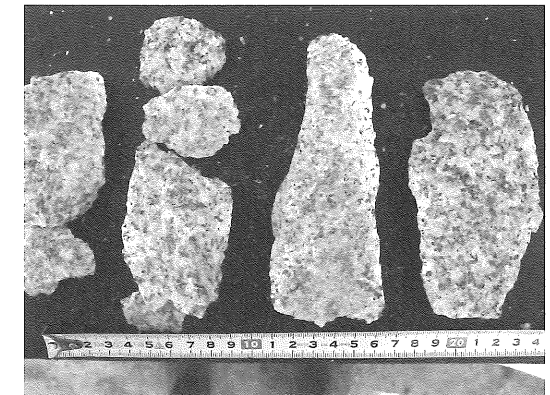
写真-6 掘削要素試験で発生したずりの岩片
