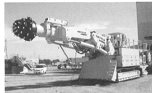
写真-2 国内最大級のブーム型トンネル掘削機(ロードヘッドSLB-350S) 1)
