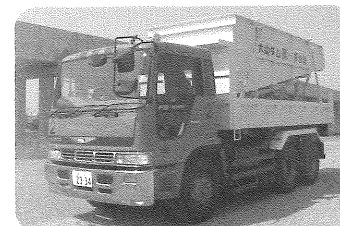
4.5 m³バケセル搭載ダンプ
