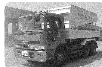
4.5m 3 ベッセル搭載ダンプ
