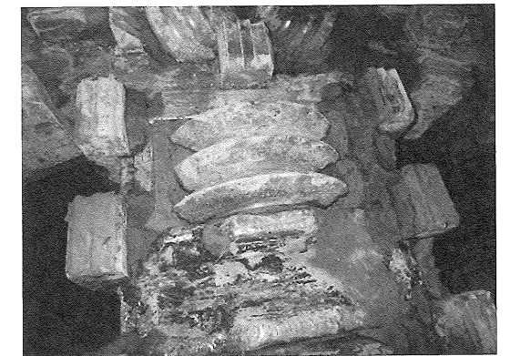
写真-11 ローラービット(到達後)
