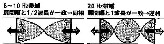
図-5 防音扉の振動の概念図
