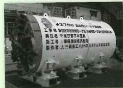
φ2780泥水式シールド RC杭(φ800, φ1000)×6本 PHC杭(φ350)×6本
