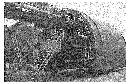
写真-5 自在配管システム搭載セントル(工場組立て状況)
