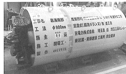
写真-1 φ900mm泥濃式推進機
