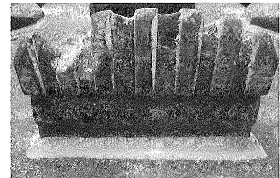
写真-7 強化先行ビット摩耗状況
