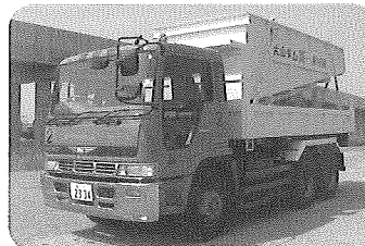
4.5m 3 ベッセル搭載ダンプ
