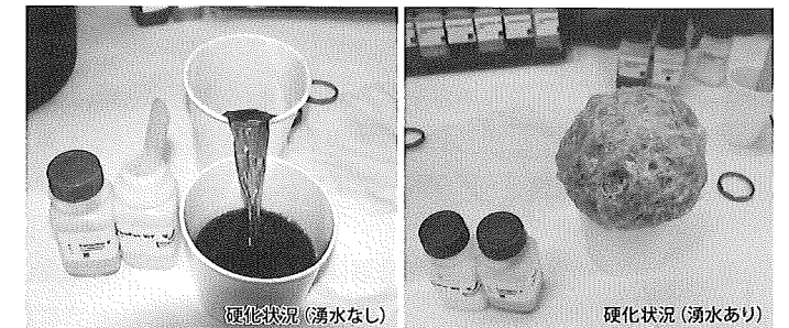
写真-1 注入材硬化状況
