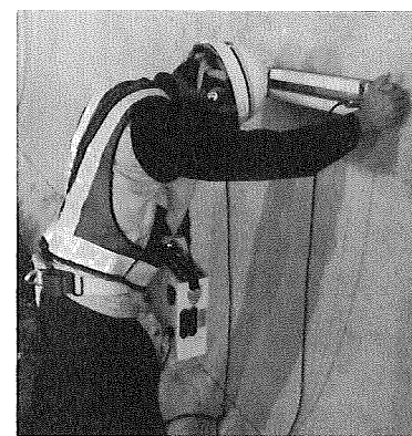
写真-6 超音波伝搬速度の測定
