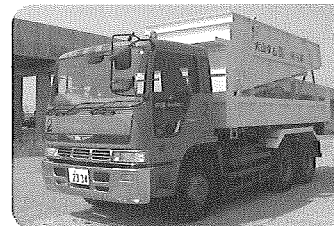
4.5m 3 ベッセル搭載ダンプ
