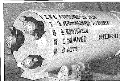
φ1016mm長距離パイプーフ掘進機(リターン回収型)
