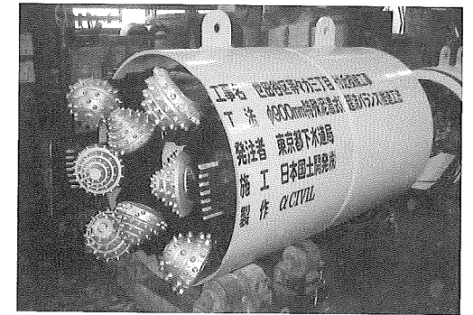
写真-3 破砕型急曲線掘進機(リターン回収型)
