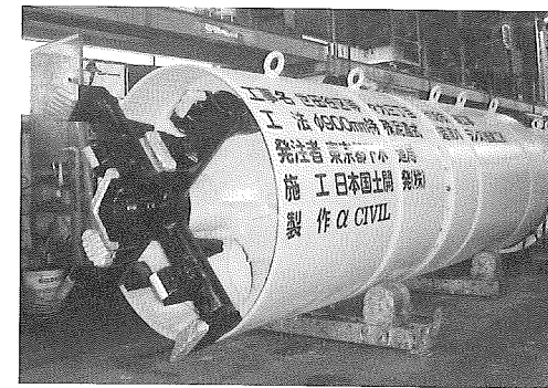
写真-2 超急曲線掘進機
