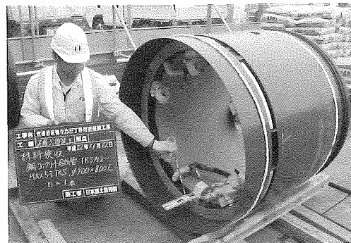
写真-4 TRS(テールボイド拡幅再構築)装置
