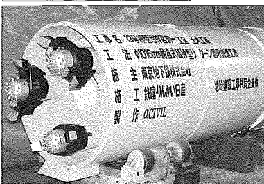
φ1016mm長距離パイプルー掘進機(リターン回収型)
