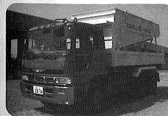
4.5m 3 ベッセル搭載ダンプ
