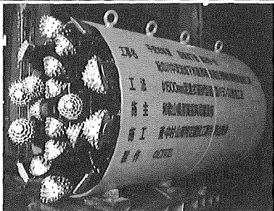
φ1500mm破碎型掘進機
