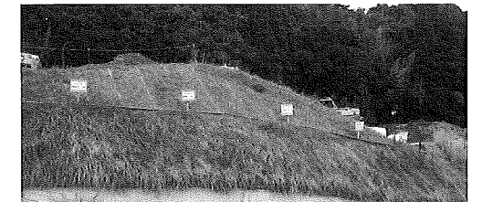
写真-8 1年後の試験区の生育状況
