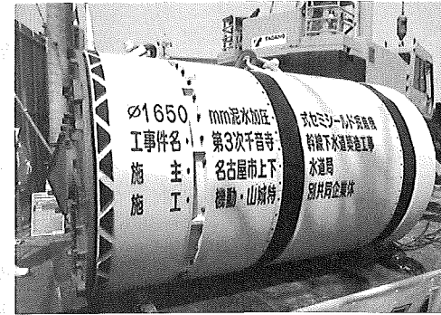
写真-4 泥水式掘進機
