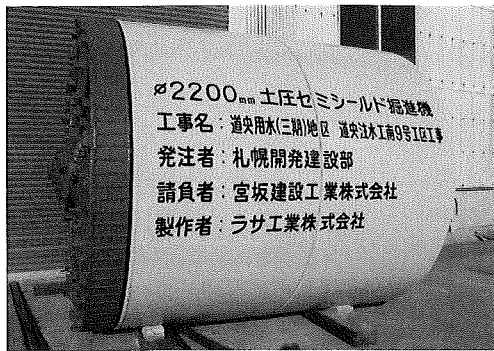
写真-3 土圧式推進機
