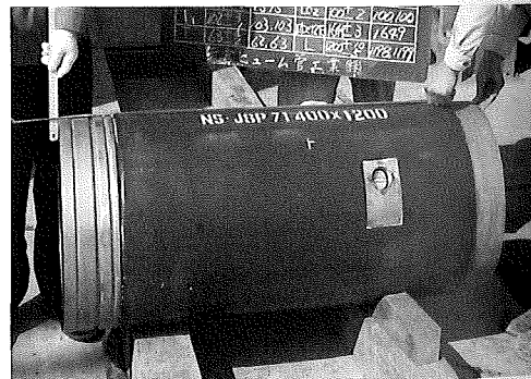
写真-7 滑材注入管
