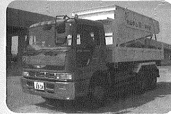
4.5m³パレット搭載ダンプ
