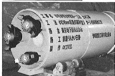
φ1016mm長距離パイプルフ掘進機(リターン回収型)
