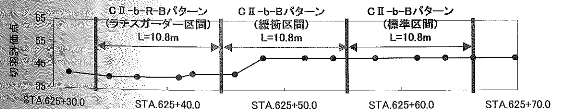
図-8 試験施工区間の切羽評価点分布状況
