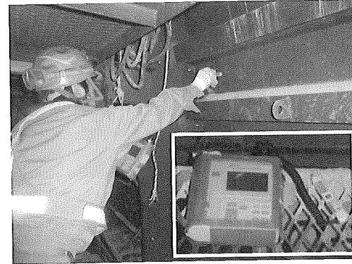
写真-4 振動エネルギー測定状況
