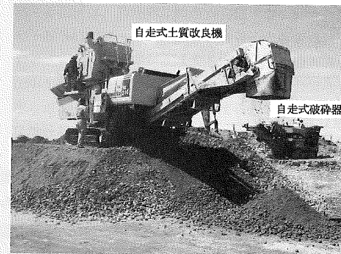
写真-2 自走式土質改良機・自走式破砕器
