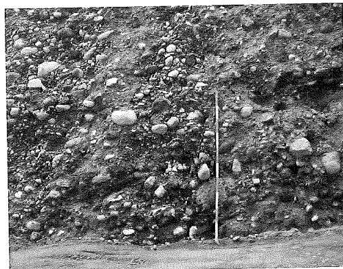
写真-1 玉石混じり砂礫層(Tm-g層)
