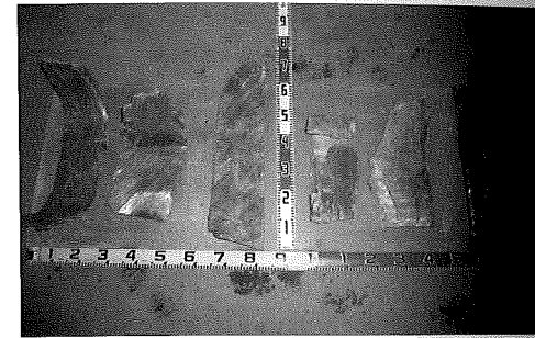
写真-3 切削・撤去した板状の鋼材
