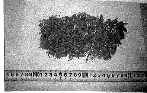
写真-2 切削・撤去したチップ状の鋼材
