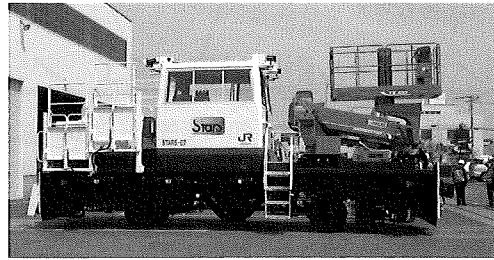
上部作業足場
