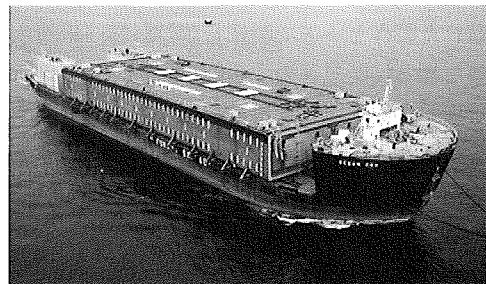
写真-2 半潜式水台船による鋼殻運搬
