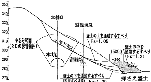
図-6 地すべり主測線での計画安全率と押さえ盛土高
