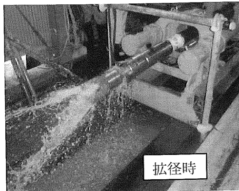
写真-4 掘径ビットの掘径・縮小状況
