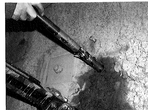
写真-5 プローブの挿入(側壁部の測定点)
