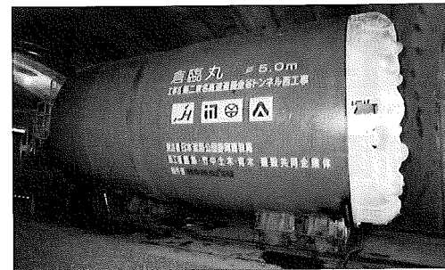
TBM仕様 ・形式：フルシールド型 ・全長：L=9m ・掘進ストローク：1.5m ・総スラスト力：16,268kN ・メイングリッパ：19,600kN
