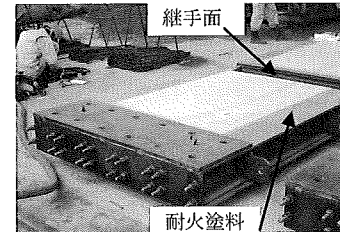
写真-5 継手部供試体
