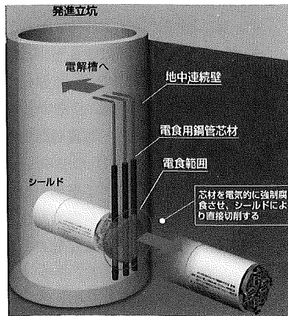
図-9 シールド直接発進概念図
