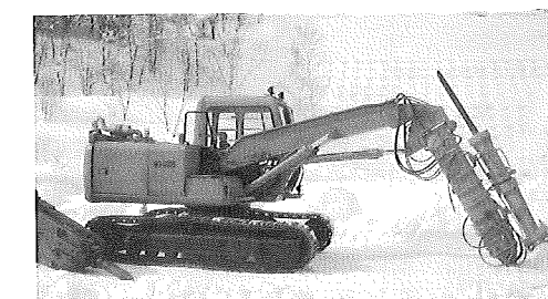
写真-7 油圧割岩機(割岩力1,100tf)
