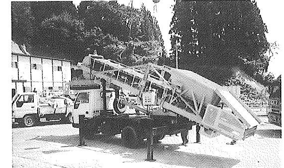
インバート積み込み機(インバルくん)の組立て状況
