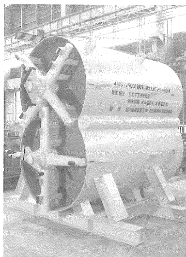
写真-2 \phi 2.5\text{m} 縦二連型DOTシールド実験機
