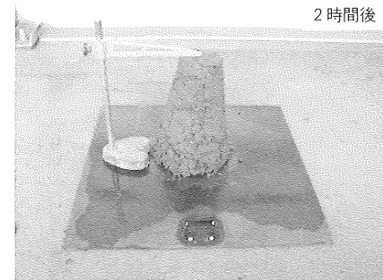
写真-3 気泡土のスランプ試験
