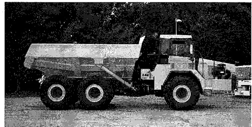
写真-5 重ダンプトラック(アーティキュレートタイプ)
