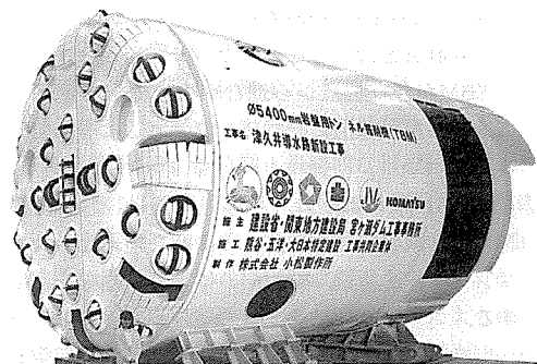
写真-3 TBM本体
