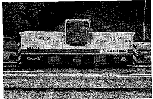
写真-4 サーボ式バッテリー機関車
