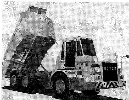
写真-2 アーテックュレートダンプトラック
