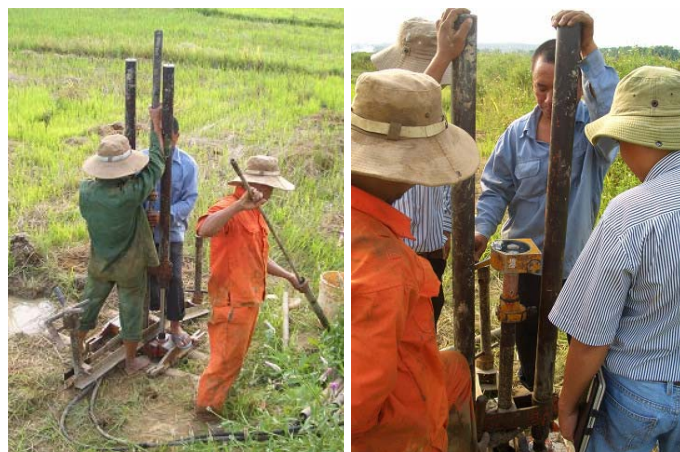
写真 2-2 ベーンせん断試験実施状況
